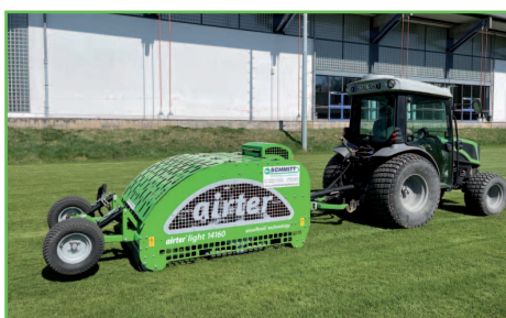
Der airtter® light 14160 ist ein pneumatisches Bodenbelüftungsgerät (Foto: Fa. Schmitt)
