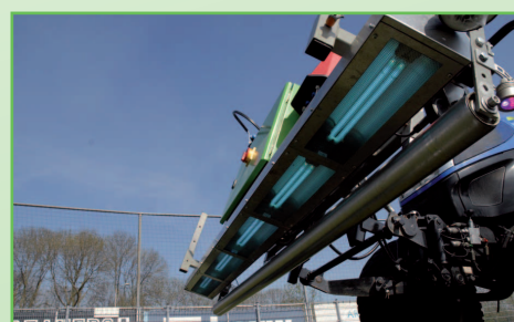
UVC-Systeme am Anbaugerät. (Foto: RHENAC GreenTec AG, Hennef)
